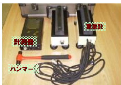
グレーディングマシンと動的ヤング係数の測定方法
