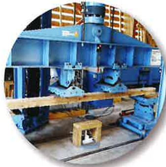
JAS 構造材 曲げ強度測定
