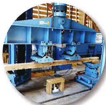
JAS 構造材 曲げ強度測定
