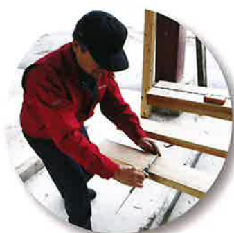
JAS 格付け検査 (寸法測定状況)
